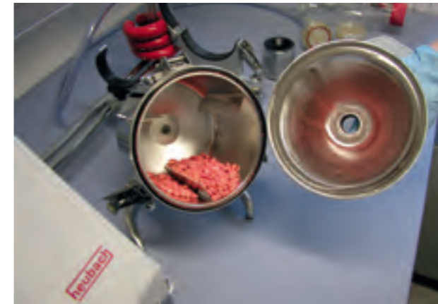
Prüfung der Abriebfestigkeit von Beizmitteln bei Maissaatgut (Heubach-Test)
