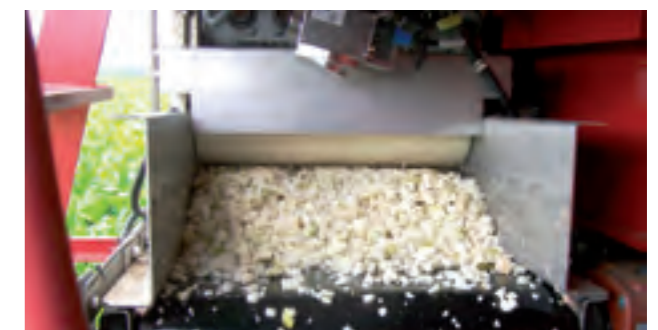
Parzellenroder mit NIRS-Technik: Neuentwicklung der Zuckergehaltsbestimmung direkt bei der Ernte
