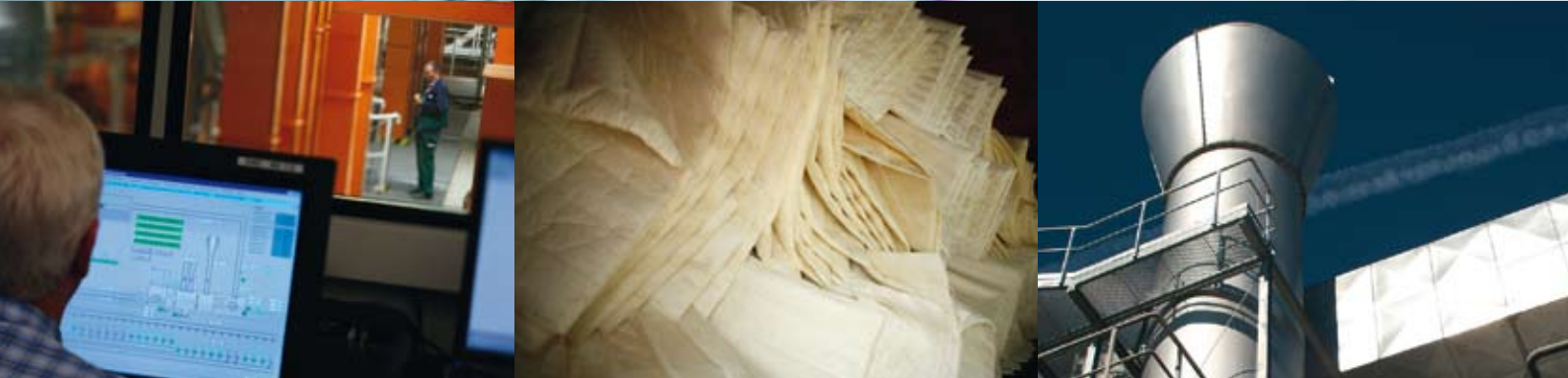
Filteranlagen sorgen für Luftreinhaltung, dabei anfallende pflanzliche Stäube werden der Verwertung oder Beseitigung zugeführt
