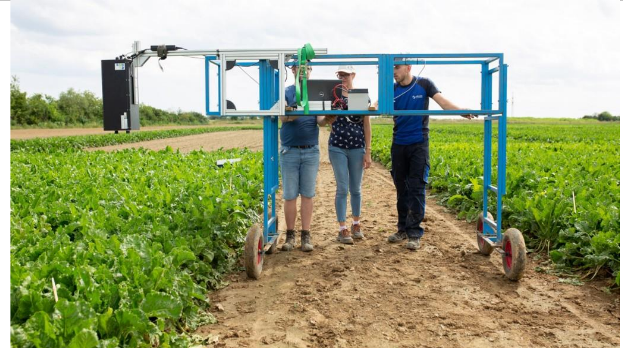
Юлихский исследовательский центр использует систему, которая определяет свет отраженной волны во время фотосинтеза.
