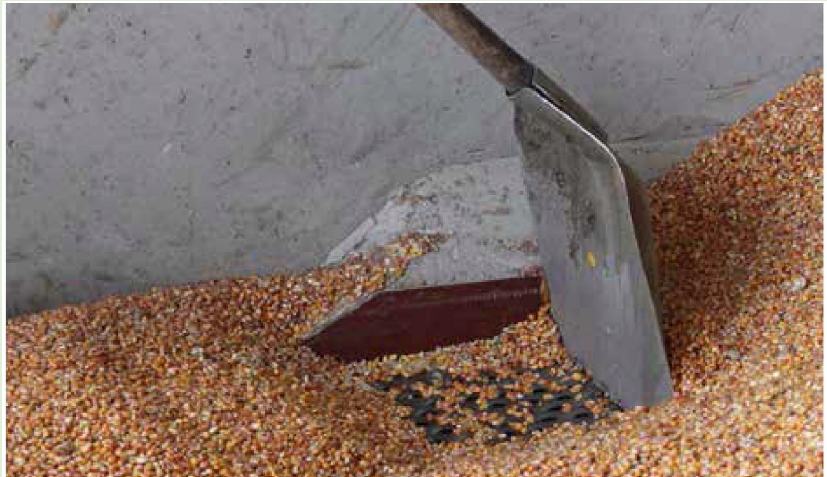
Abb 4: Mais-Trocknung mit Schlitzbrückenblechboden
