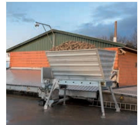
Der Biocracker – ein neuer Trockenentsteiner und -zerkleinerer für Rüben
