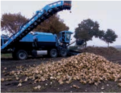
Entsteinung und Verladung mit der Waschmaus
