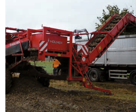
Rübenverladung mit Verladebändern (Quelle: Holmer)
