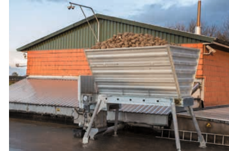
Der Biocracker – ein neuer Trockenentsteiner und -zerkleinerer für Rüben
