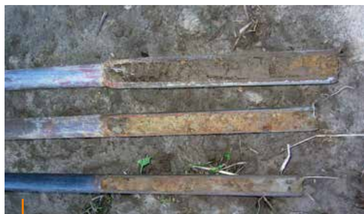
Próbki na N-min pobieramy za pomocą lasek próbobiorczych o różnej długości i średnicy. Laski możemy wykonać we własnym zakresie z rur 1/2 cala, 3/4 cala i 1 cal.
