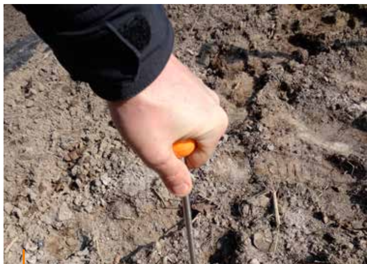
Ubicie gleby możemy sprawdzić za pomocą ręcznego penetrometru glebowego.
