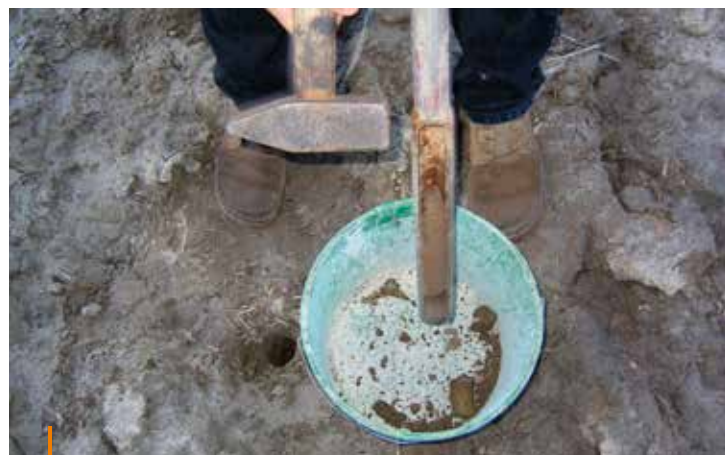
Glebę z każdej pobranej warstwy mieszamy w wiadrze i rozdrabniamy. Następnie z próby zbiorczej pobieramy próbę średnią.
