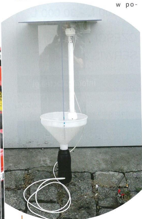
Pułapka świetlna do odławiania i monitoringu naltów ciem omacnicy.
