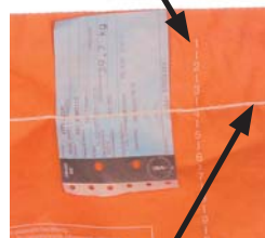
Linia zszycia worka, która jest jednocześnie plombą opakowania
