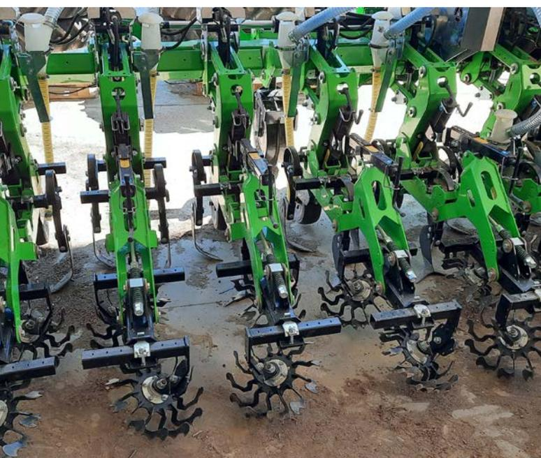
Foto 1: Esempio di sarchiatrice di precisione con dita rotanti
