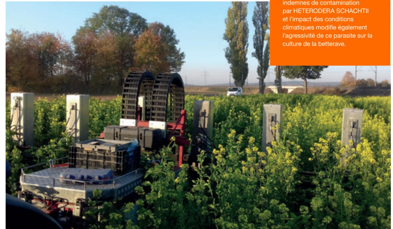
Prototype de prélèvements de terre équipé de 6 organes de prélèvements en action dans un couvert végétal (octobre 2018).
