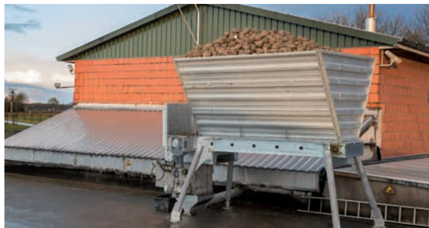
Abb. 16: Der Biocracker – ein Trockenentsteiner und -zerkleinerer für Rüben Quelle: indunorm
