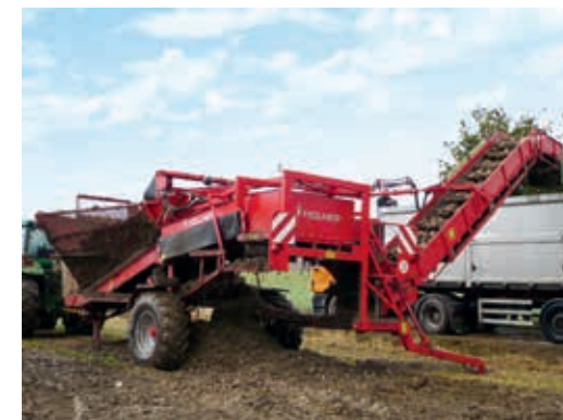
Abb. 12: Verladung mit einem Reinigungslader Quelle: HOLMER
