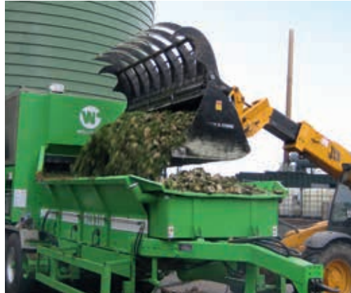
Abb. 30: Zerkleinerung der Rüben mit einem WILLIBALD-Schredder
