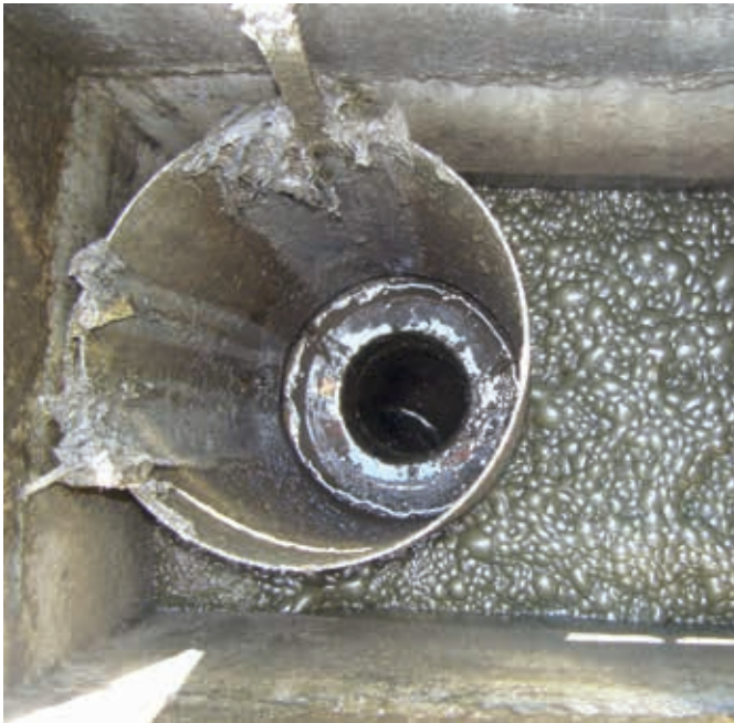
Abb. 10: Schaumbildung in Zusammenhang mit Rübeneinsatz ist in der Praxis gut beherrschbar.
