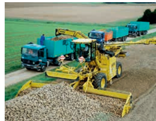
Abb. 11: Verladung mit der „Rübenmaus“ Quelle: ROPA
