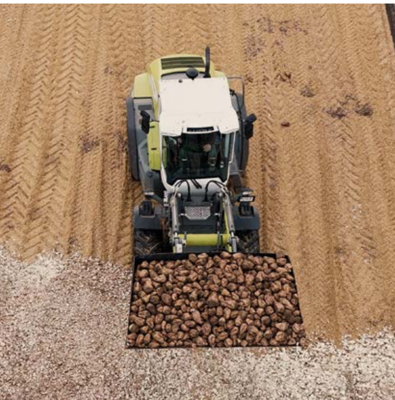
Abb. 1: Schnitzelschaufel RS 2400 beim Aufbringen von Rübenschnitzeln auf eine bestehende Maissilage im Fahrsilo
