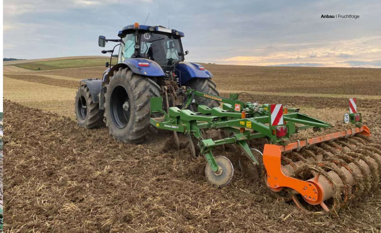
Tiefe Bodenbearbeitung – Schwergrubber (Foto: Brunotte)
