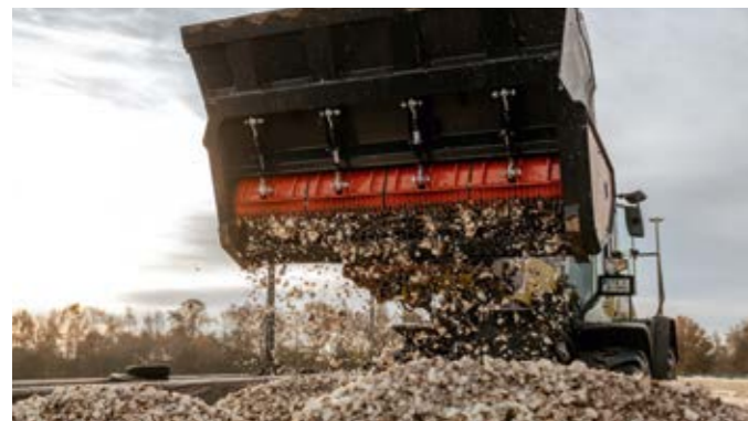
Die Schnitzelschaufel RS 2400 beim Aufbringen von Rübenschnitzeln auf eine bestehende Maissilage im Fahrsilo
