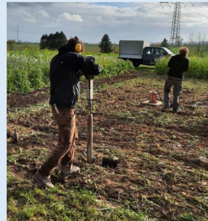
Tiefe Wurzelbeprobung mittels Rammkernsondierung im KWS Zwischenfrucht-Versuchsfeld
