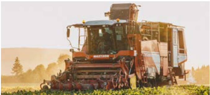
Der Roder erntet und verarbeitet zwei 3-reihige Parzellen gleichzeitig. Die Ertrags- und Qualitätsparameter sind direkt für die Züchtung verfügbar.
