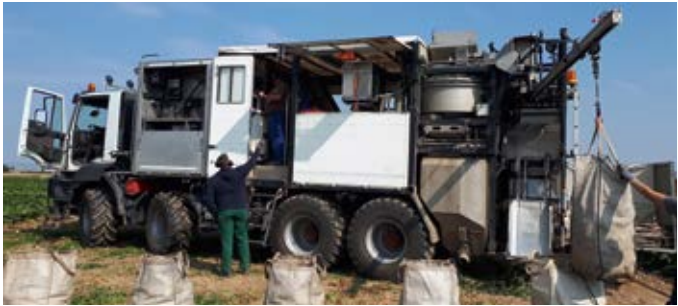
2. Verarbeitung der Rüben im Beetmobil. Der gewonnene Rübenbrei wird tiefgefroren und zur Analyse in das Labor nach Klein Wanzleben gebracht.
