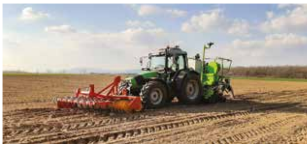
Фиг. 12. Приложение на комбинирани агрегати за предсеитбена подготовка и сеитба с GPS навигационна система (KWS селекционна станция в Унгария)
