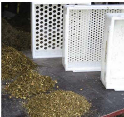
Die Schüttelbox besteht aus einem dreiteiligen Siebkastensystem, das das gesiebte Futter durch die verschiedenen Sieblochgrößen in drei Fraktionen teilt. In Tabelle 13 sind die Partikelgrößen der drei Siebe mit den jeweils gewünschten Anteilen in der Ration dargestellt.
