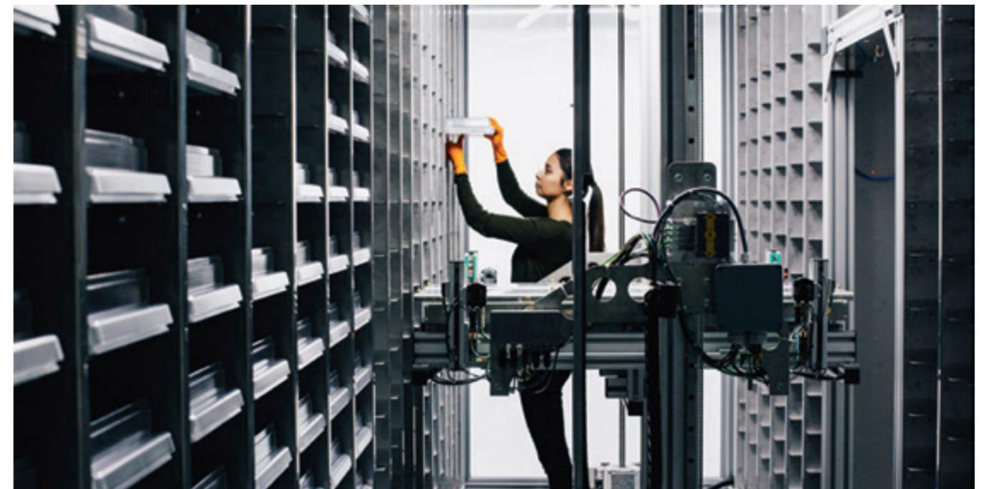
GESA, le robot qui déplace les plateaux avec les semences en test de germination, photographie le développement de la germination et remet les plateaux dans le système de rangement.
